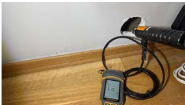
Måleresultatet viser LO, dvs. ikke målbar fukt i gipsplate. 6 vekt% er laveste verdi instrumentet kan måle.
