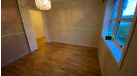
1. etasje Plassering av laser ved kontroll av soverom. Det er målt 6 mm høydeforskjell gjennom rommet. TG 1
