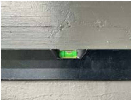
Ved nivellering med vader er det registrert en høydeforskjell på 13 mm.
